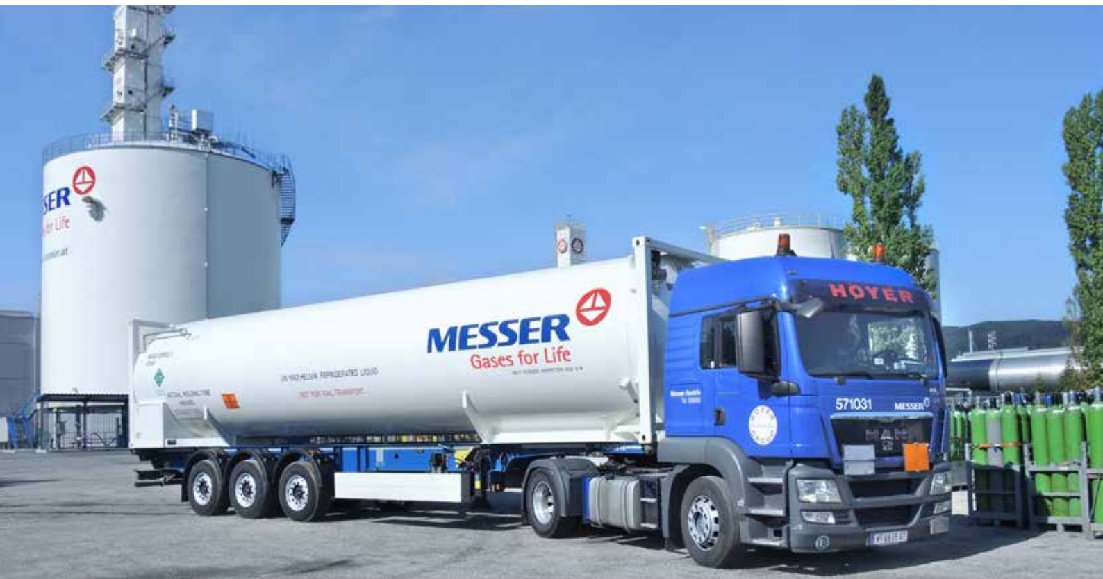
Iso, container pour hélium liquide
