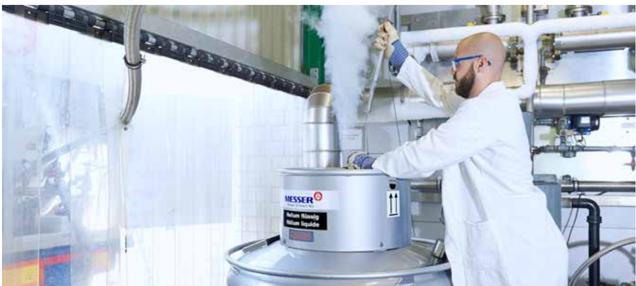
Transfert d'hélium liquide à Lenzburg
